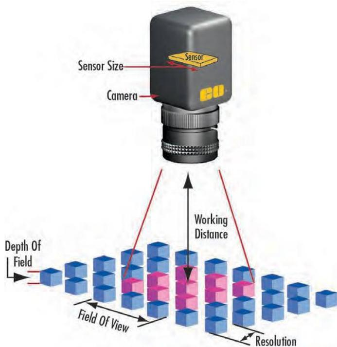
Figura 2. Illustrazione dei parametri fondamentali di un sistema di imaging.
